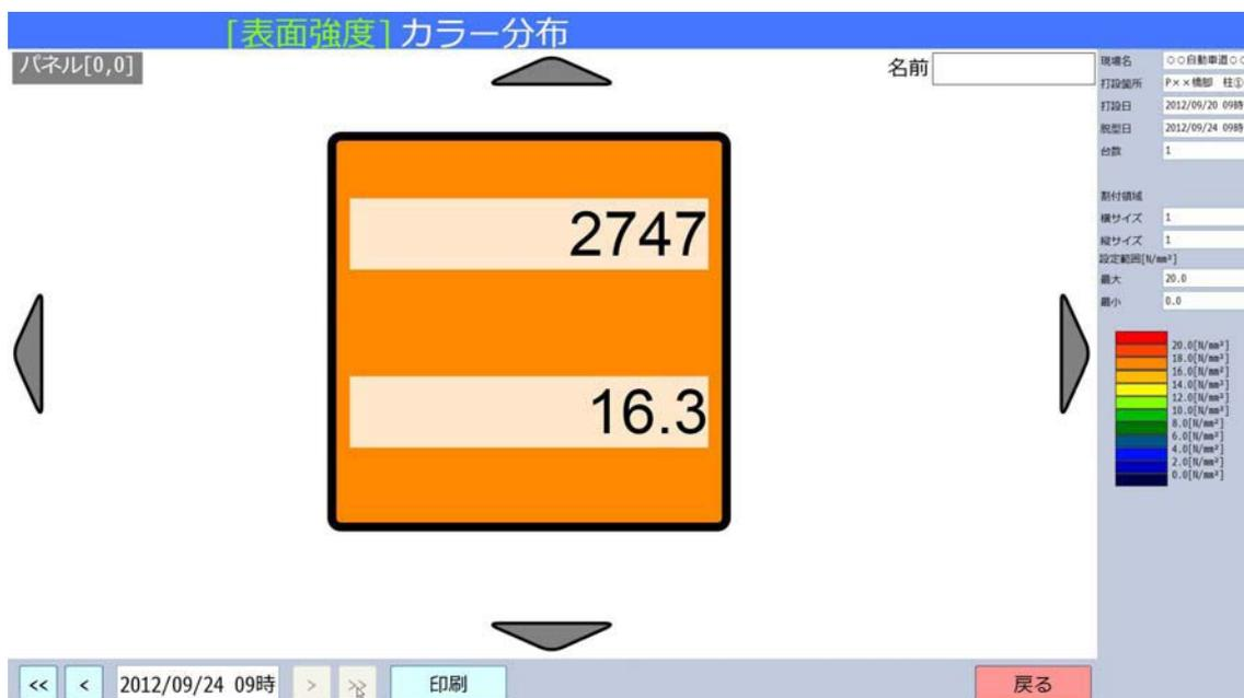
図 13 タイル配置された樹脂型枠の推定強度マッピング
